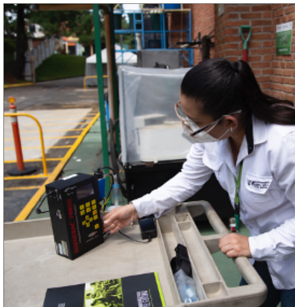
Figura 3. Equipo de medición de concentración de gases del Centro de Procesos Industriales, Universidad del Valle de Guatemala. Foto: Universidad del Valle de Guatemala.
